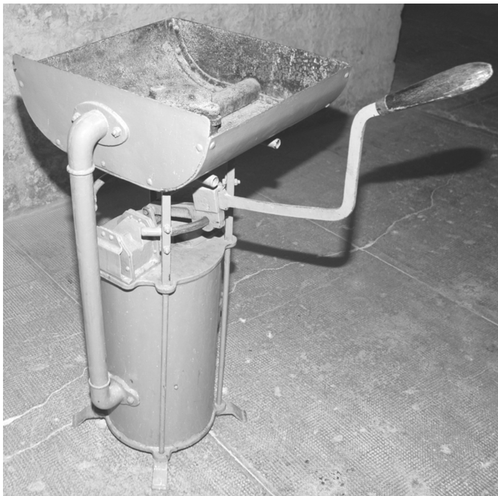
Figure 3 : Forge portative à soufflet cylindrique, musée du fort de La Pompelle. Photo Roland Bruneau.
